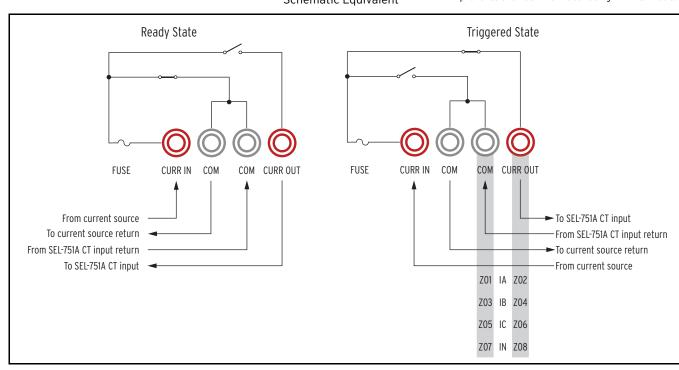
SEL-4520 Arc-Flash Test Module
